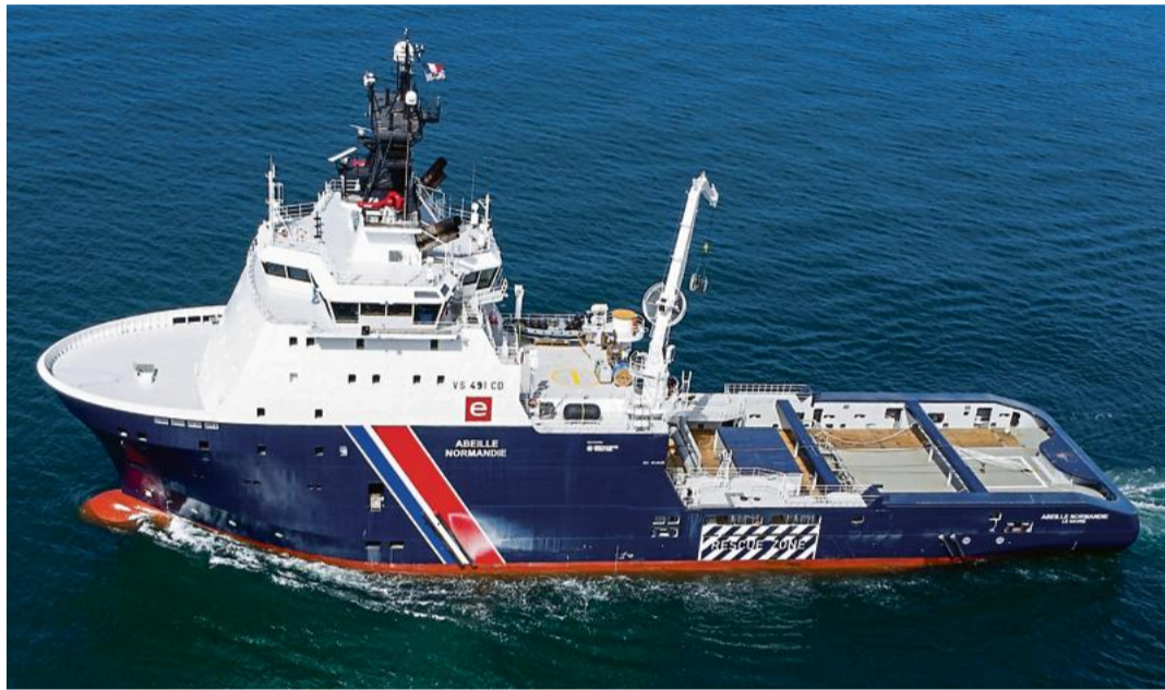
Le navire est l'un des plus puissants remorqueurs d'assistance au monde, avec ses 22.000 CV et une capacité de traction de 280 tonnes. Photo Abeilles International
